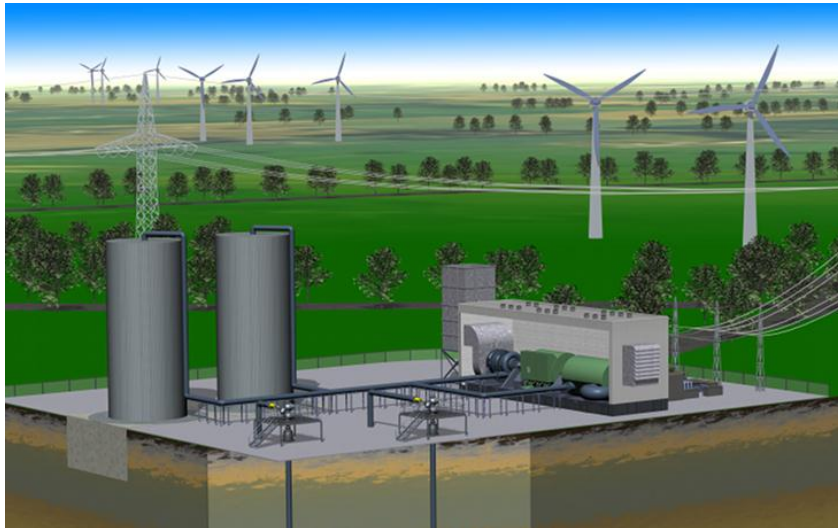
Schematische voorstelling van een perslucht opslaglocatie (bron: climatetechwiki.org)
